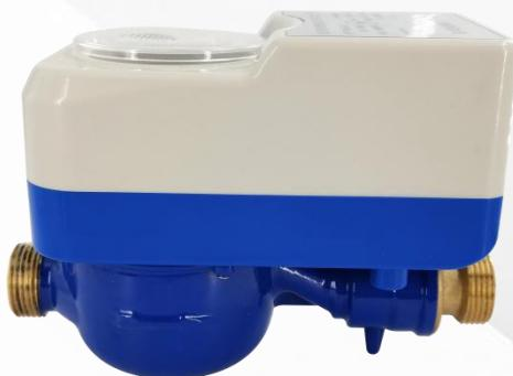
基表分为两种，其中口径DN15-DN32采用水平旋翼机械式水表；数据上传采用4Gcat1，模式：单表安装4Gcat1通讯模块，直接发送数据至水务公司服务器。
